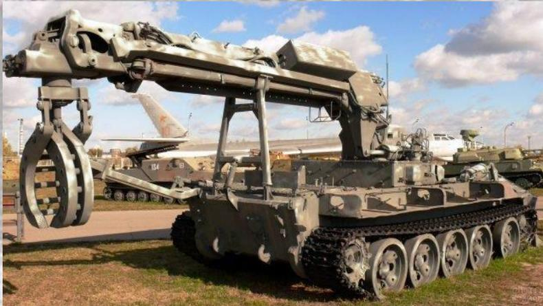
Камуфлированная боевая инженерная машина разграждения ИМР-2М
